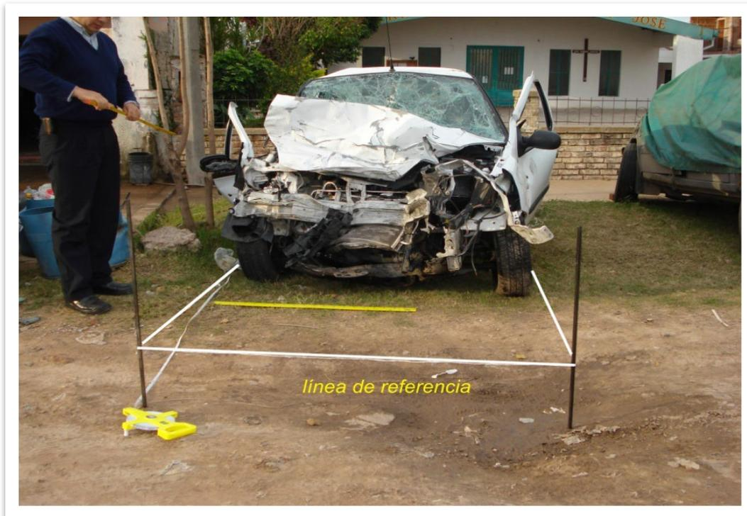
Figura 4.24: formación de la línea de referencia sobre un terreno irregular.
